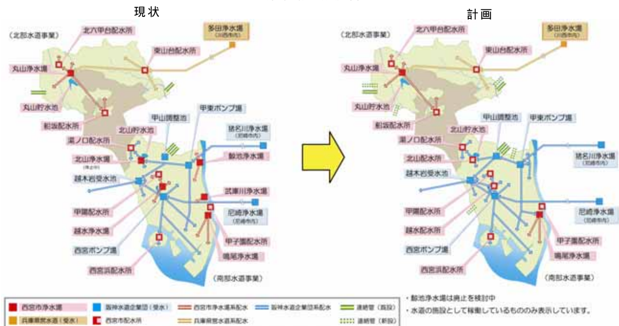
浄水場の統廃合
