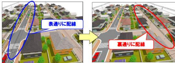
図 4.3 裏配線方式の例
